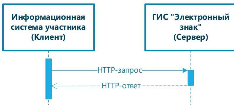
**Рисунок 1 – Схема межсистемного взаимодействия по API-протоколу**
